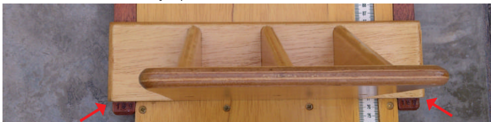
FIGURA 51 Corredera alineada ya que la zona de lectura está alineada con el corte
