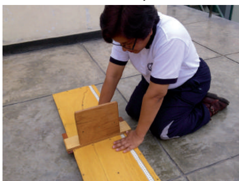
FIGURA 51 Corredera alineada ya que la zona de lectura está alineada con el corte
